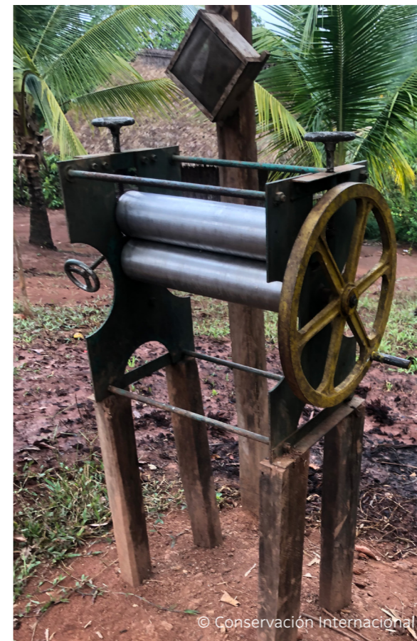
Las laminadoras permiten obtener látex seco de calidad.
